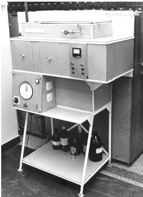
Fotografia 1.7. Pierwszy polski ciśnieniowy chromatograf ciekowy zbudowany w latach 1962-1964 [4]
