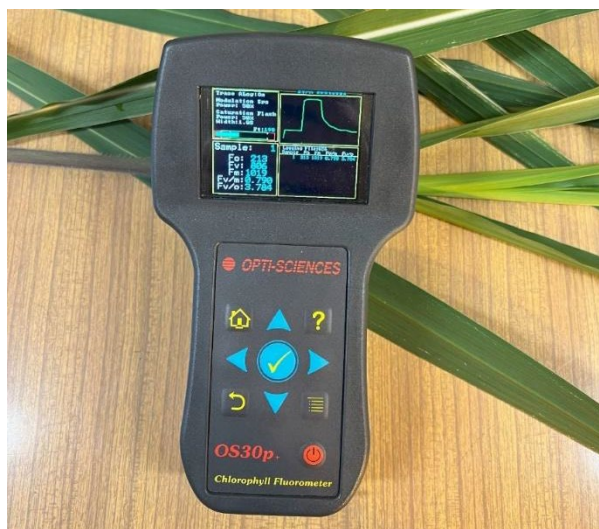
Fotografia 1. Przyrząd do mierzenia fluorescencji chlorofilu OPTI-SCIENCES OS 30p+
