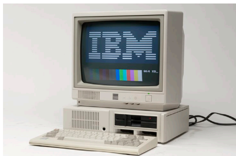
IBM XT - 4,77 MHz, 128 KB RAM i 10 MB HDD. W Polsce po 1990 r.
