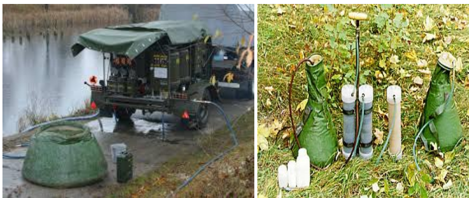
Rysunek 7. Przykładowe filtry FPW, od lewej: filtr FPW-30 M oraz stacja FPW-2000
