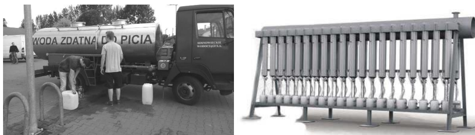
Rysunek 9. Dystrybucja wody przy użyciu cysterny oraz przykładowe urządzenie do zbiorowej dystrybucji wody
